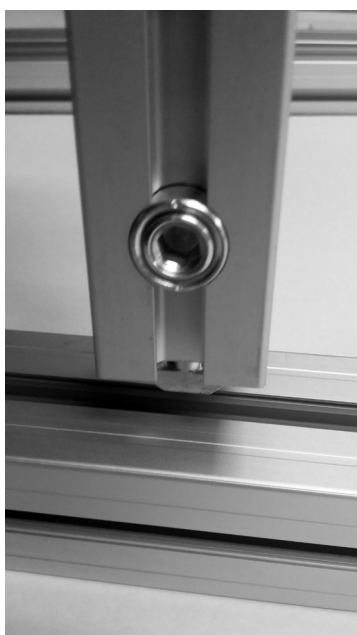
nasazení spojky do drážky
